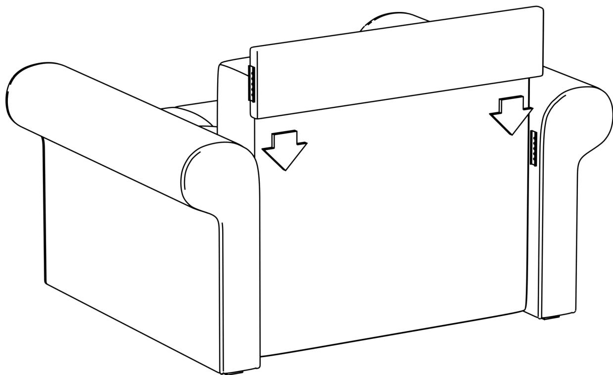
5. Устанавливаем заднюю планку на место с помощью соединителей.
